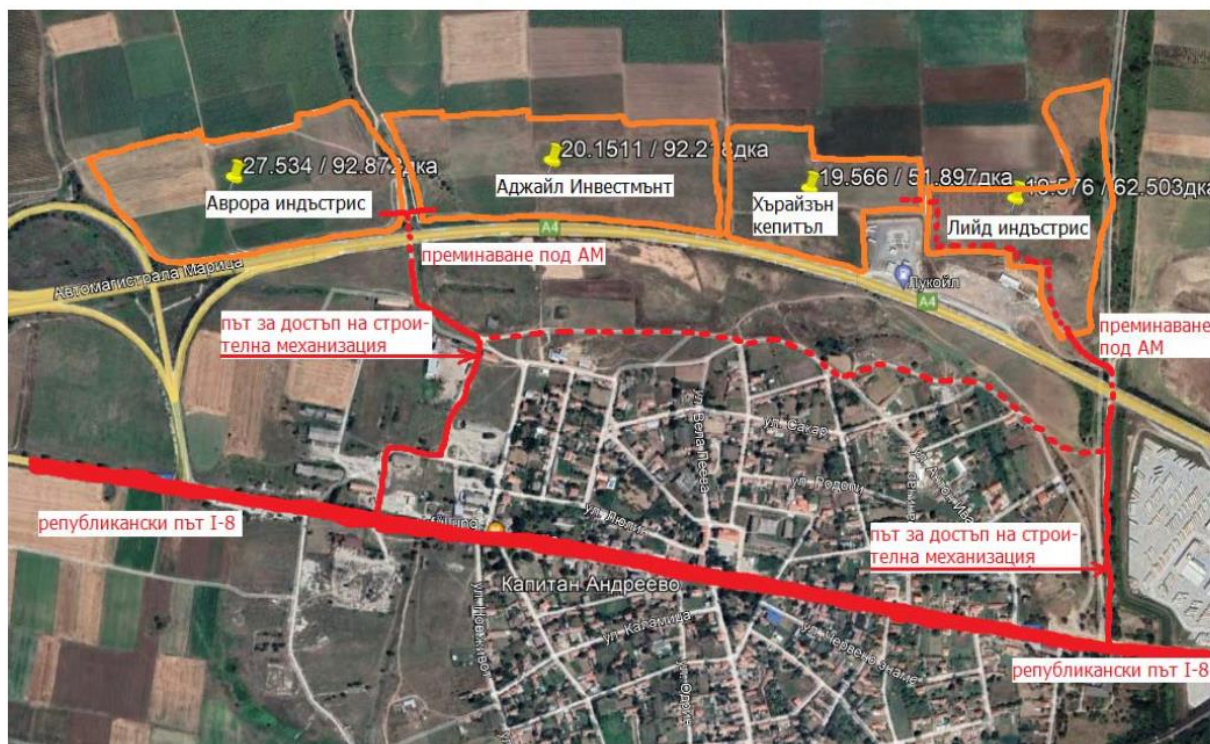
Фигура № 1.2-6 Схема на маршрутите на строителните машини до обектите по време на строителството
