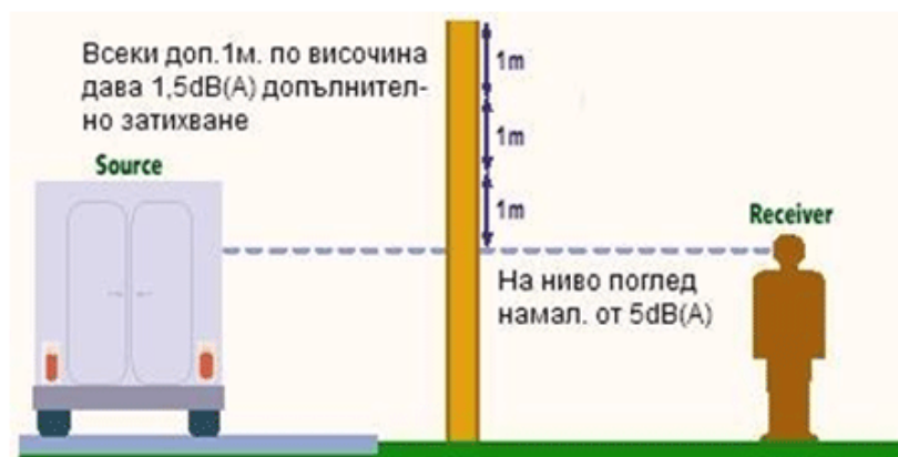
Фигура 5.4.1. Минимална изискуема височина на стените
