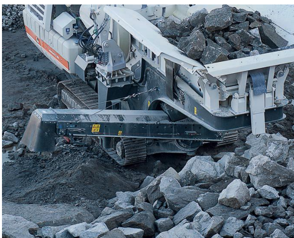
Фиг. 1.6.1.3. – Общ вид на мобилна трошачно-сортировъчна инсталация (ТСИ)
