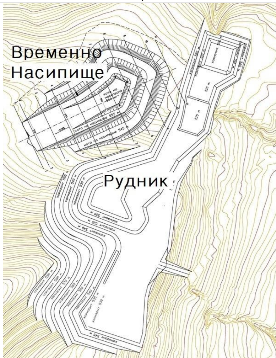
Фиг.1.5.1.1 – Ситуационен план на находище „Седефче“ с нанесено временно насипище за минния отпадък – участък „Централен“
