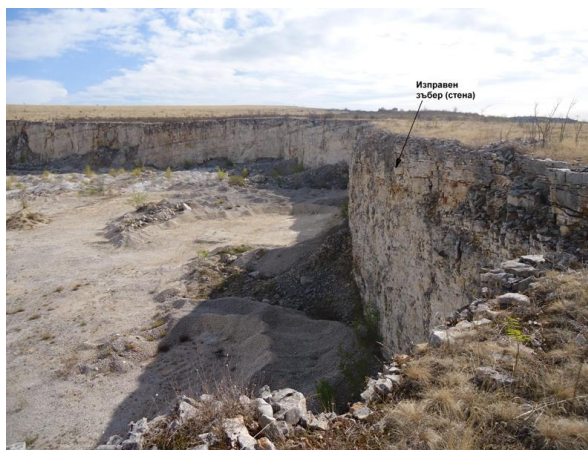
Фиг. 1.6.1.2- Снимка на аналогичен начин на разработване на находище по открит начин с изграждане на стъпало на хоризонта (зъбер-стена), което минимизира въздействието от взривните работи
